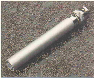
Eine Kompensationsdatei 'linearisiert' den Frequenzgang des Electretmikros.
